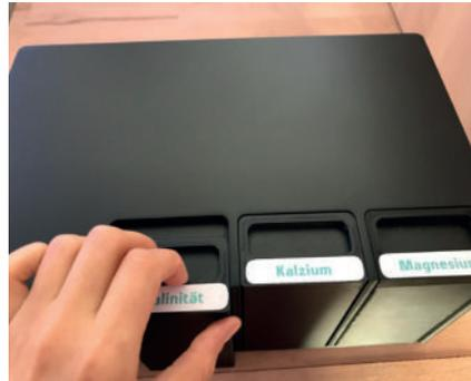
**1.** Entferne die verbrauchte Kartusche aus dem Korallenwächter, indem Du sie nach vorn herausziehst. Entferne die Verschlussstopfen der neuen Kartusche und verschließe damit die verbrauchte. Achtung! Immer die gelben Verschlussstopfen zuerst abnehmen, damit der entstandene Druck entweichen kann. Lege zur Sicherheit ein Küchentuch unter.
