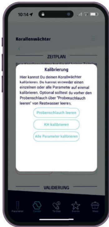
Im Anschluss kannst Du die Kalibrierung starten. Die Kalibrierung läuft automatisch ab und dauert ca. 30-45 Minuten. Dabei wird die Referenz fast vollständig verbraucht.
